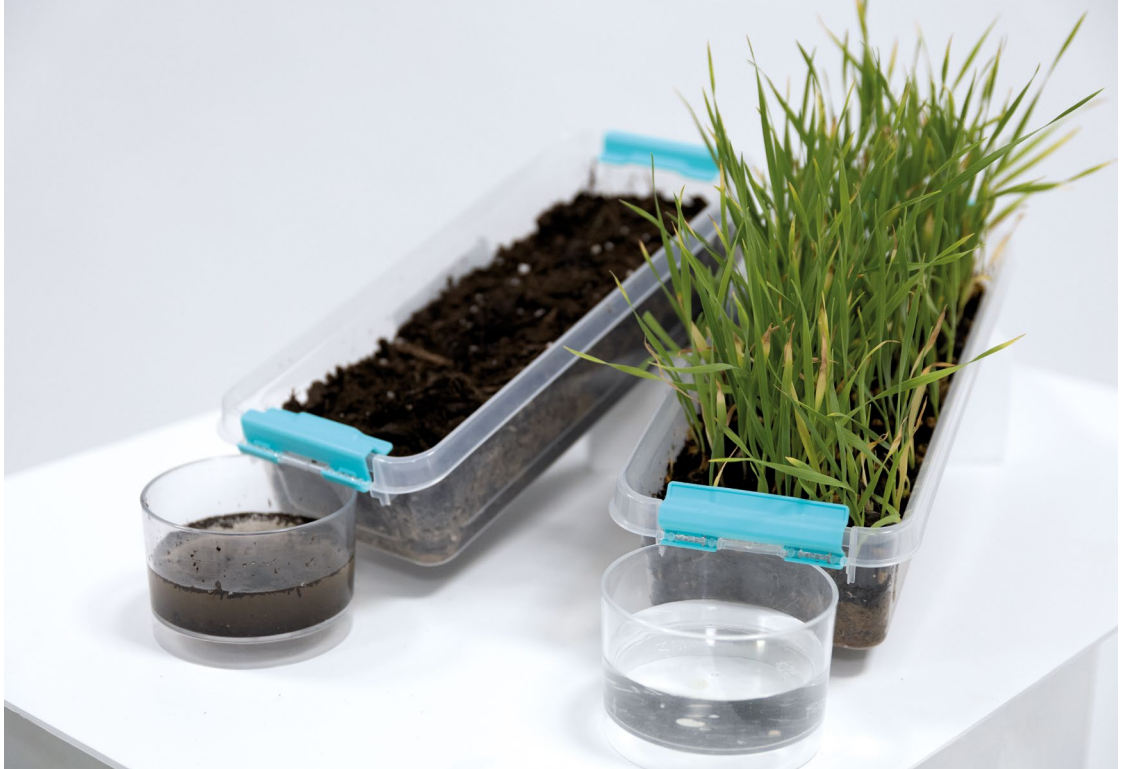
Εικόνα 2. Η σημασία της βλάστησης στην προστασία του εδάφους από τη διάβρωση - Μοντέλο
